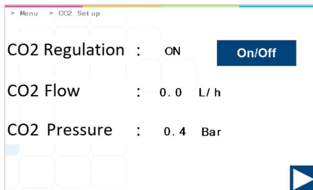
Obrázok 13.25 Zobrazenie podponuky Nastavenie CO 2 v multiroom IVF inkubátoroch MIRI® TL6 a MIRI® TL12
