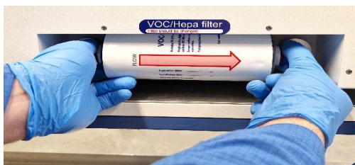
Obrázok 12.2 Postup vkladania a vyberania filtra VOC/HEPA
