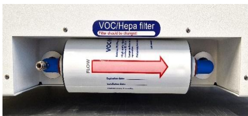
Obrázok 12.3 Správne nainštalovaný filter VOC/HEPA
